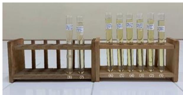
**Gambar 4.** Nanopartikel perak-kitosan-formaldehid yang diinteraksikan dengan ion Fe(III) pada berbagai konsentrasi. 1 ppm (1), 3 ppm (2), 5 ppm (3), 7 ppm (4), 10 ppm (5), 15 ppm (6), 25 ppm (7), 50 ppm (8)
