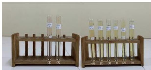
**Gambar 3.** Nanopartikel perak yang diinteraksikan dengan ion Fe(III) pada konsentrasi. 1 ppm (1), 3 ppm (2), 5 ppm (3), 7 ppm (4), 10 ppm (5), 15 ppm (6), 25 ppm (7), 50 ppm (8)
