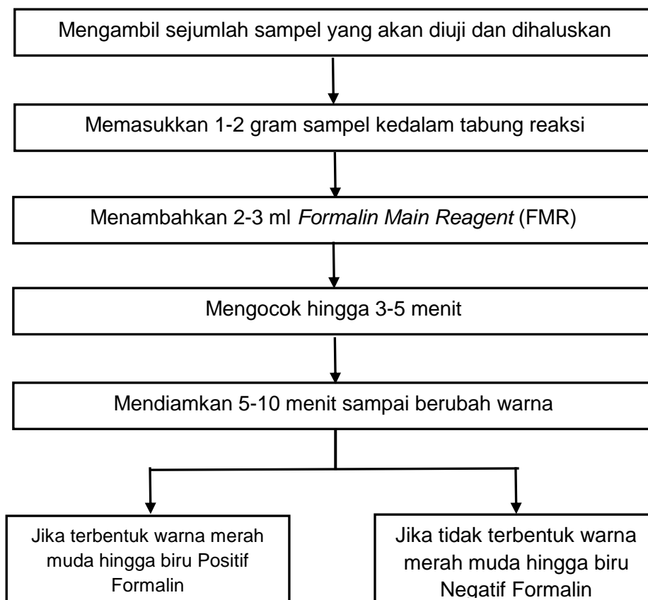
Gambar 3. Diagram Alir Prosedur Uji Formalin secara Kualitatif dengan Formalin Main Reagent (FMR) (Mahdi, 2008).
