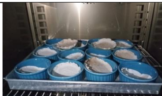
Proses pengovenan menggunakan suhu 105°C selama 1 jam.
