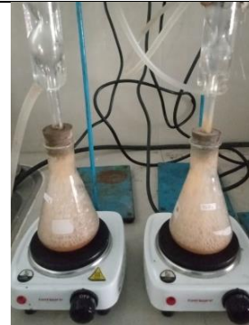
Proses pemanasan menggunakan refluks
