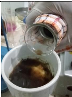
Hasil pemanasan yang disaring menggunakan kertas saring dan vakum pump
