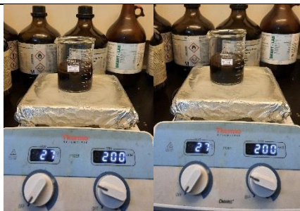
Larutan air sumur Fe 50 ppm + 5 gram ampas kopi di aduk dengan stirrer kecepatan 200 rpm selama 45 menit
