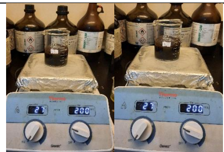
Larutan air sumur Fe 50 ppm + 10 gram ampas kopi di aduk dengan stirrer kecepatan 200 rpm selama 45 menit
