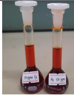
Larutan standar Fe 50 ppm dan sampel air sumur 50 ppm
