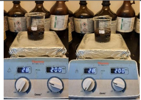
Larutan standar Fe 50 ppm + 5 gram ampas kopi di aduk dengan stirrer kecepatan 200 rpm selama 45 menit
