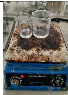
Larutan dipindah ke dalam gelas piala dan ditambah larutan H_2SO_4 4 N dan brom water
