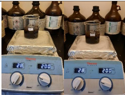
Larutan standar Fe 50 ppm + 10 gram ampas kopi di aduk dengan stirrer kecepatan 200 rpm selama 45 menit
