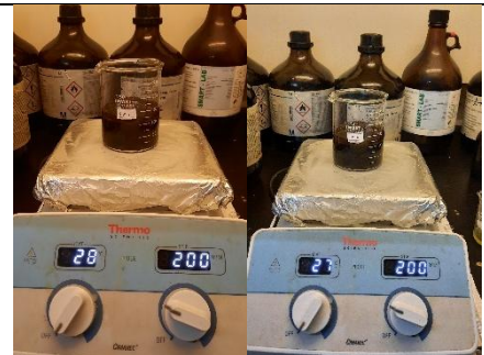
Larutan standar Fe 50 ppm + 15 gram ampas kopi di aduk dengan stirrer kecepatan 200 rpm selama 45 menit
