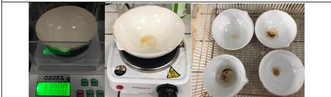
Pengujian alkali bebas, uji asam lemak bebas, uji larut petroleum eter, bahan yang tidak larut etanol
