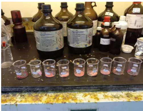
Proses preparasi sampel larutan uji, kontrol positif, kontrol negatif dan larutan standart Rhodamin B dilakukan dalam lemari asam
