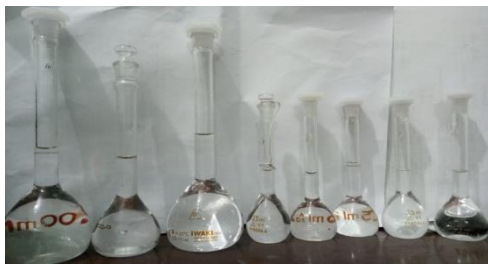
Pembuatan larutan deret standar
