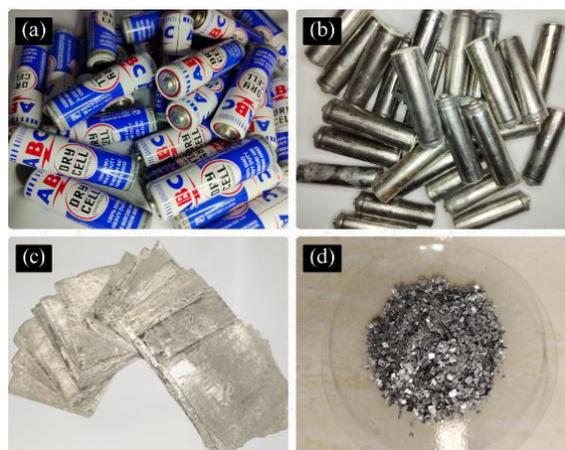
**Gambar 1** (a) Baterai primer AA 1,5 V; (b) Lapisan kedua baterai: lempeng Zn; (c) lempeng Zn setelah dibersihkan; (d) Potongan Zn hasil preparasi
