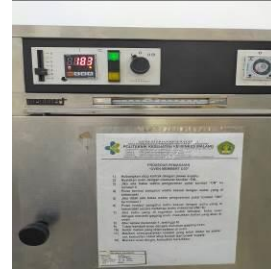
Oven digunakan untuk sterilisasi panas kering.
