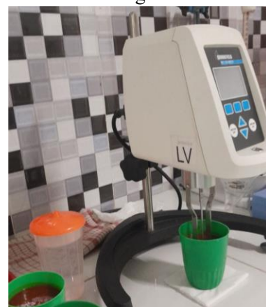
Melakukan pengujian viskositas saus tomat
