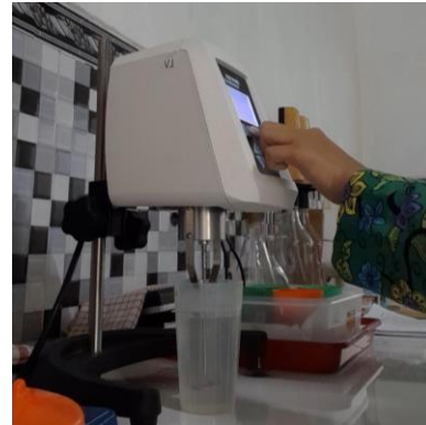
Menyalakan viscometer untuk kalibrasi
