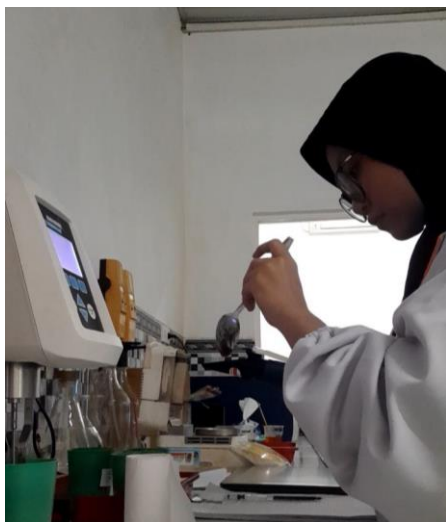
Melakukan pengujian kadar garam saus tomat
