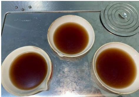
Proses Ekstraksi Jahe Merah Dengan Menggunakan Waterbath
